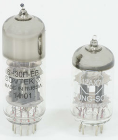
Tutto il guadagno di Unico 150 è ottenuto con triodi. La ECC83 è un classico per gli stadi di ingresso, mentre la 6H30 si incontra più raramente pur essendo un componente di caratteristiche notevolissime, tra i pochi in grado di pilotare direttamente la capacità d'ingresso di una bancata di mosfet di potenza.
